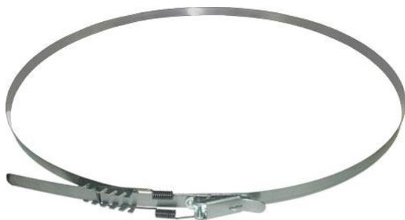
Для крепления мешков используются специально изготовленные хомуты, из конструкционной рессорно-пружинной стали (0,5x16 мм), с регулируемыми пружинными застёжками. Обеспечивают быструю и надёжную фиксацию.
