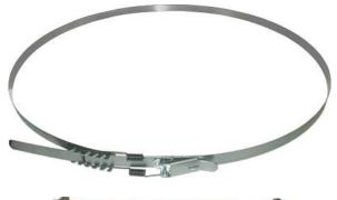
Для крепления мешков используются специально изготовленные хомуты, из конструкционной рессорно-пружинной стали (0,5x16 мм), с регулируемыми пружинными застежками. Обеспечивают быструю и надежную фиксацию.
