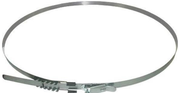
Для крепления мешков используются специально изготовленные хомуты, из конструкционной рессорно-пружинной стали (0,5x16 мм), с регулируемыми пружинными застежками. Обеспечивают быструю и надежную фиксацию.
