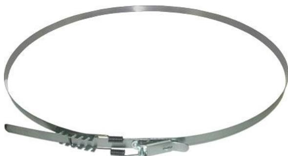
Для крепления мешков используются специально изготовленные хомуты, из конструкционной рессорно-пружинной стали (0,5x16 мм), с регулируемыми пружинными застежками. Обеспечивают быструю и надежную фиксацию.
